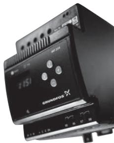
> Модуль MP 204 обеспечивает защиту от сухого хода, перекоса фаз, превышения температуры обмоток эл. двигателя. Отсутствие необходимости в дополнительных электродах и кабеле. Экономия времени и денежных средств при монтаже.
